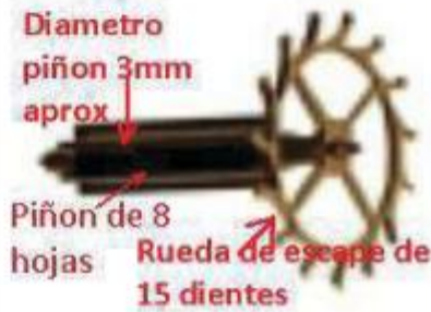
Ilustración 7. Rueda de escape con piñón. Dimensiones importantes.
