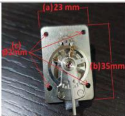
Ilustración 6. Dimensiones Platina (a) Ancho de platina, (b) largo de platina y (c) agujeros de platina
