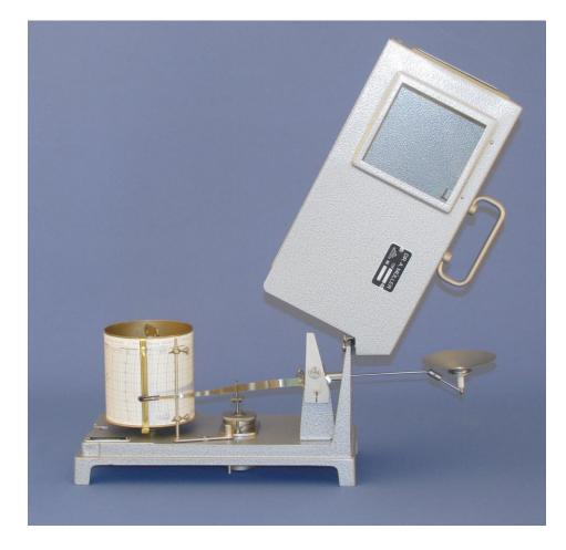
Der Tau-Schreiber von Kessler dient zur Aufzeichnung des Tauniederschlags, dessen Menge von der Temperatur, dem Wasserdampfgehalt und der Bewegung der Luft sowie von der Temperatur der auffangenden Oberfläche abhängt, die ihrerseits durch ihre Ausstrahlung bedingt ist.
