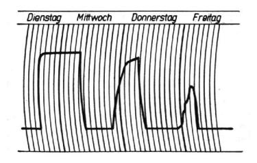
Bild 2: Unterschiedliche Registrierung der Niederschläge (schematisch, 1/3 nat. Gr.)
