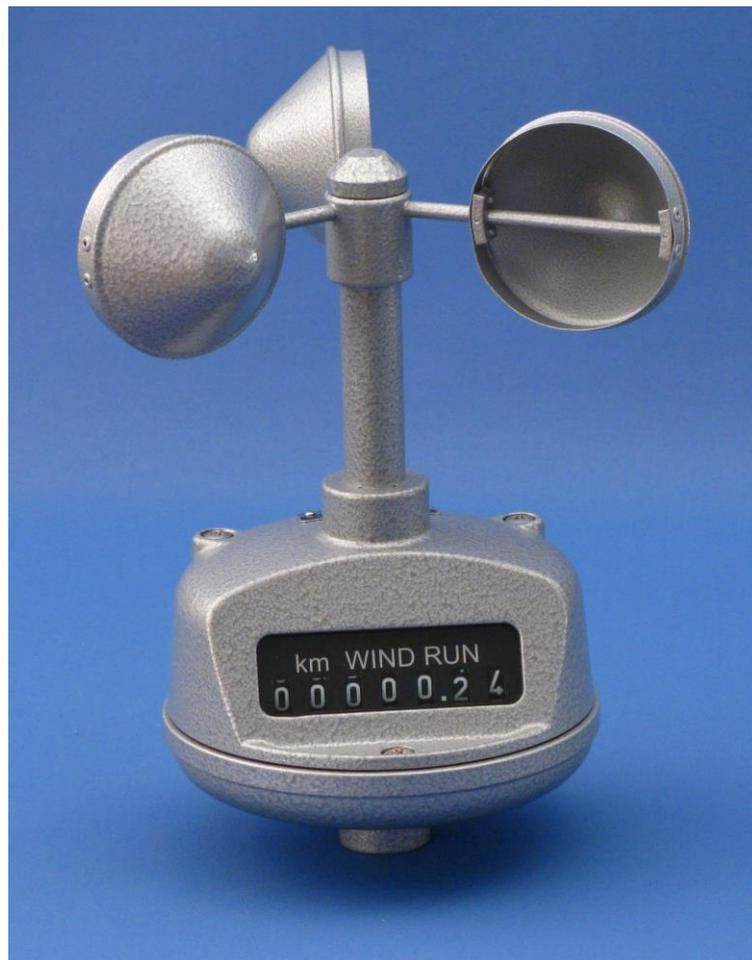
Das wetterfeste, große Zählwerk-Anemometer 91ge wird für die Windmessung in der freien Atmosphäre über beliebig lange Zeiträume verwendet. Es ist für den Dauerbetrieb im Freien bestimmt und wird zur Messung von Luftströmungen in Höhen von etwa 1,5 m abwärts eingesetzt. Durch das im Winkel von 30° nach oben geneigte Fenster kann der Stand des Zählwerkes abgelesen werden. Die Zahlenhöhe beträgt 8 mm.
