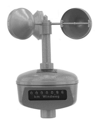
Das wetterfeste, große Zählwerk-Anemometer 91g wird für die Windmessung in der freien Atmosphäre über beliebig lange Zeiträume verwendet. Es ist für den Dauerbetrieb im Freien bestimmt und wird zur Messung von Luftströmungen in Höhen von etwa 2 m ab aufwärts eingesetzt. Durch das im Winkel von 30° nach unten geneigte Fenster kann der Stand des Zählwerkes direkt oder bei größerer Aufstellungshöhe von unten mit Hilfe eines Fernglases abgelesen werden. Die Zahlenhöhe beträgt 8 mm.
